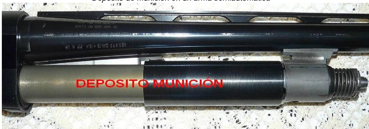
Deposito de munición en un arma semiautomática
