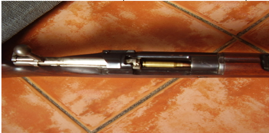
Introducción de un cartucho en el depósito de munición de un arma de repetición
